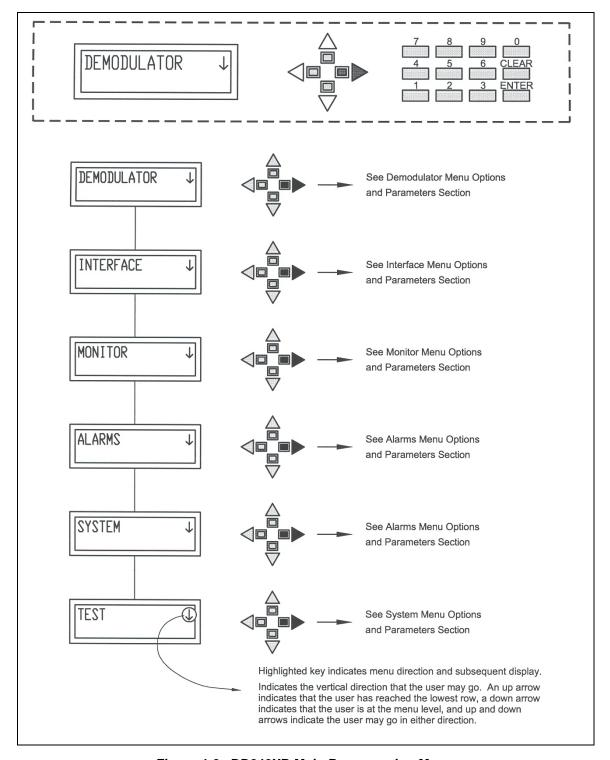
Figure 4-2. DD240XR Main Programming Menu
